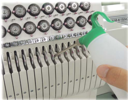
Barra de agulha (Parte inferior) "A" na figura direita
