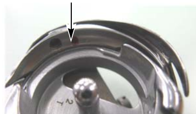
Furo de lubrificação (marca vermelha)
